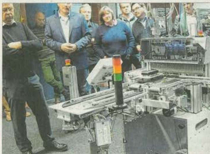
Der fahrbare Roboter „Robotino“ (im Vordergrund) trägt eine Art Ampel an seinem Transporttisch. Hier zeigt er an, ob alles im grünen Bereich ist.
